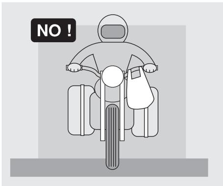
No sujete jamás objetos voluminosos, pesados y/o peligrosos en el manillar, en los guardabarros, y en las horquillas: esto causaría una respuesta del vehículo más lenta en las curvas y comprometería, de manera inevitable, la manejabilidad del mismo.
